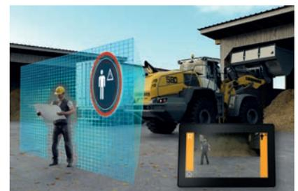
assistent reduziert automatisch die Geschwindigkeit des Radladers bis zum Stillstand, sobald die aktive Personenerkennung ein Warnsignal ausgibt. Die Gefahrenkarte visualisiert mögliche Risikozonen am Betriebsgelände mithilfe von GPS-Daten im eigenen Datenübertragungs- und Ortungssystem LiDAT.
