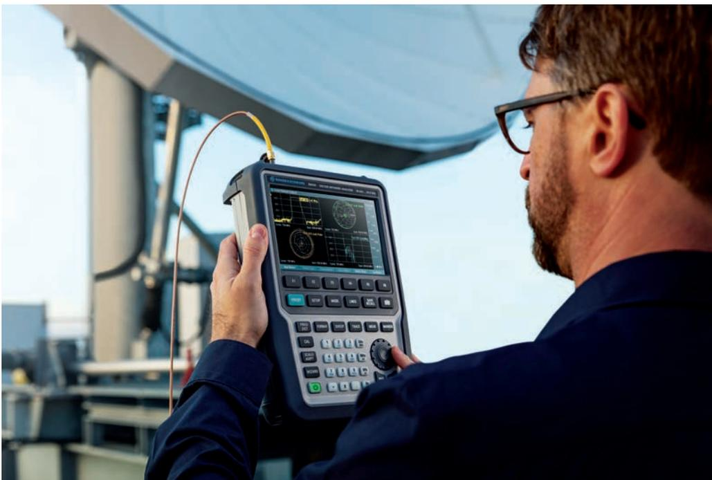
Der R&S ZNH ist standardmäßig mit wichtigen Funktionen wie Kabel- und Antennenmessungen und vollständigen Zweitor-S-Parametermessungen ausgestattet.
