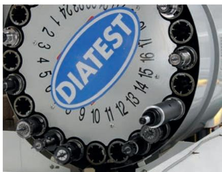
Die Messungen von Bohrungen, Fasen, Gewindetiefen und glatten Tiefen können im Produktionsprozess selbst erfolgen – aber auch losgelöst davon. Der äußerst schnelle Messzyklus läuft 24 Stunden am Tag, sieben Tage die Woche, und liefert 100 Prozent der Messdaten.
