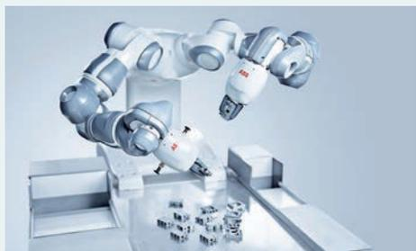
Um den Anforderungen an eine voll flexible Fertigung gerecht zu werden, hat ABB mit YuMi® einen kollaborativen Zweiarmeroboter für die Kleinteilmontage entwickelt.
